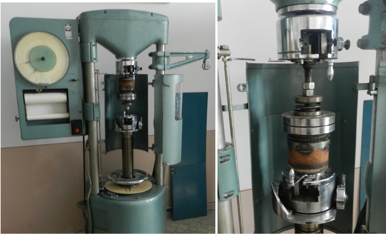
Рис. 3. Общий вид стенда, на котором установлена предохранительная муфта
